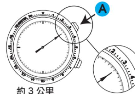
\* 請注意，秒錶秒針以 1/5 秒鐘間隔移動（根據機型），故它有時會偏離測距儀的刻度數。測距儀刻度盤只能用於當測得的時間少於 60 秒鐘的時候。
