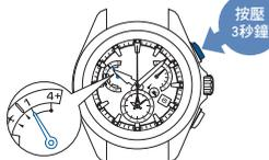
※ 指示器指針對準「低」或者
