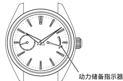
\* 若连续三至五天佩戴 12 个小时以上，则手表的发条将被上满弦。当然，发条的上弦状况根据实际使用的情况不同亦会发生变化。例如佩戴手表的小时数或手臂的摆动程度。因此，最好经常性地观察动力储备指示器，以确认手表的剩余动力。
