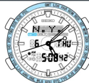
\* 嘩嘩聲發響，時針和分針自動開始表示轉換後的時間。方式回到時間 / 日曆方式上，同時轉換後的城市名在捲動顯示窗內表示。
